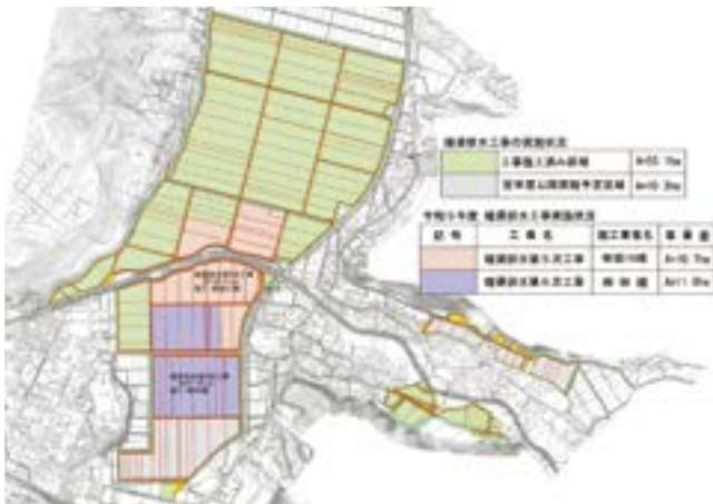
荒川地区 暗渠排水工事実施状況図
